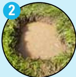
Remplir le trou d'eau jusqu'à environ 5 cm du bord et laisser l'eau s'infiltrer durant 1 h, en complétant le niveau d'eau si besoin.
