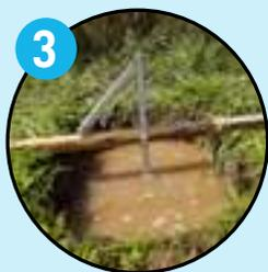
Remplir à nouveau le trou et lancer un chronomètre pour mesurer le niveau d'eau en cm. Relever les valeurs :
